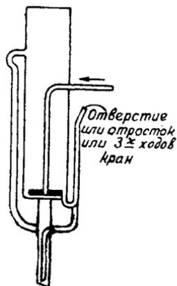
Рис. 198. Экстрактор для экстрагирования жидкостей посредством тяжелых растворителей.
