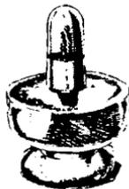
Рис. 15. Спиртовая горелка (стеклянная).
