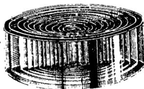
Рис. 78. Набор кристаллизаторов.
