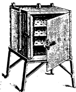
Рис. 211. Сушильный шкаф с водяной рубашкой.
