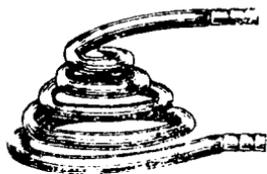
Рис. 191. Змеевик для перегрева пара.
