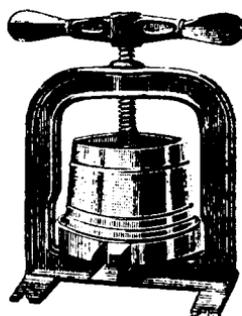
Рис. 178. Винтовой пресс закрытый.
