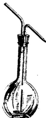
Рис. 69. Колба для дистиллированной воды (промывалка).
